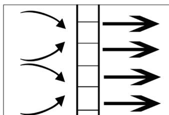
Integrierter Strömungsgleichrichter - keine Einlaufstrecken notwendig
