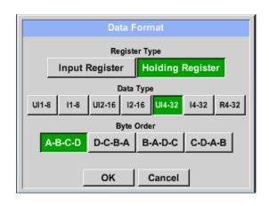
Selection Register Type Holding Register, Data Type *U1(32b)* und Byte Order *A-B-C-D* **HWord** LWord HByte LByte HByte LByte 29235175522 => ΑE 41 56 Data Order 1.Byte 2.Byte 3.byte 4.Byte 56 A-B-C-D ΑE 41 52 D-C-B-A 52 56 41 ΑE B-A-D-C 41 ΑE 52 56 C-D-A-B 56 52 ΑE 41
