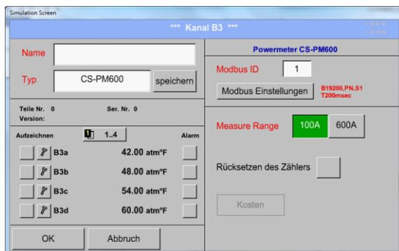
Mittels des Knöpfen **Measure Range 100A** oder **600A** kann der Messbereich für die Strommessung ausgewählt werden.
