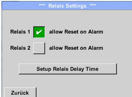
Bei einer Aktivierung der *Relais*-Knöpfe ist es möglich mittels der angezeigten Alarmmeldung eine Relaisabschaltung zuzulassen.
