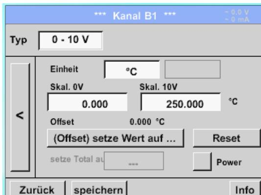
Mit dem *Setze-Wert-auf-* Taste (*Offset*) können die Messdaten des Sensors auf einen bestimmten Wert gesetzt werden. Die positive oder negative Differenz des *Offsets* wird angezeigt.
