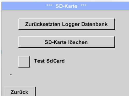
Mit Betätigen der Taste *Zurücksetzen Logger Datenbank* werden die aktuell gespeicherten Daten für die Verwendung im DS400 gesperrt. Die Daten bleiben jedoch auf SD-Card gespeichert und sind für eine externe Verwendung verfügbar.
