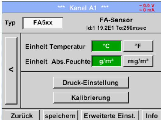
Auswahl der Einheiten Temperatur und Feuchte durch Betätigen der Felder °C, °F,  $g/m^3$  oder  $mg/m^3$ .
