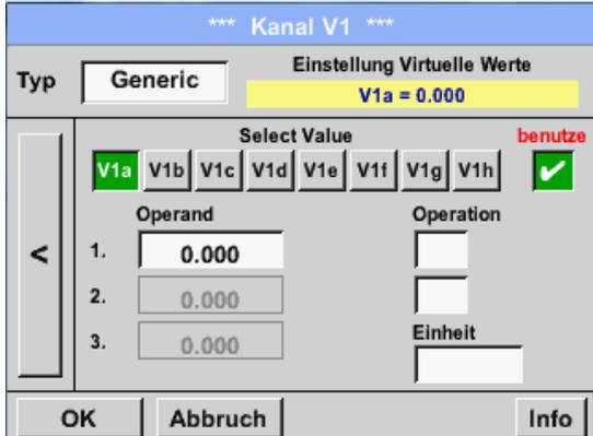
Durch drücken auf das Textfeld *1st Operand* gelangen Sie in eine Auswahlliste mit den verfügbaren Hardware-Kanälen, virtuellen Kanälen und konstant Wert.
