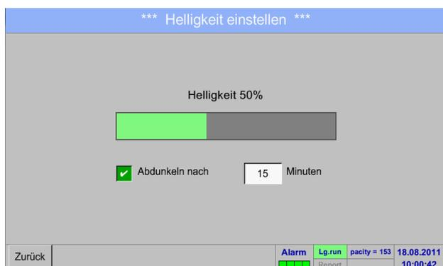
Mit Hilfe des **Abdunkeln-nach**-Taste kann, nach Ablauf eines zu definierenden Zeitintervalls (hier nach 15 Minuten), die **Helligkeit** auf das Minimum herabgesetzt werden.
