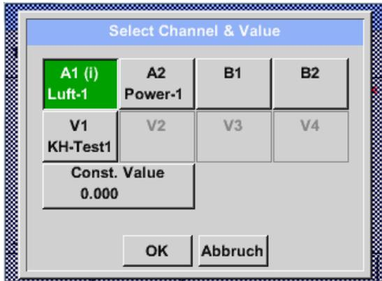
Durch drücken eines Hardware oder virtuellen Kanal Taste z.B. *A1* öffnet sich eine Auswahlliste mit den pro Kanal verfügbaren Messkanälen bzw. Messwerten incl. definierten virtuellen Kanälen.
