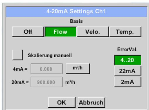
Die Skalierung des 4-20mA Ausganges kann automatisch (Default) oder manuell erfolgen.
