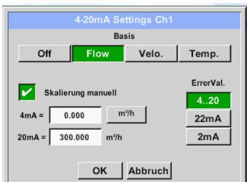
Unter *Error Val* wird festgelegt was im Fehlerfall am Analogausgang ausgegeben wird.
