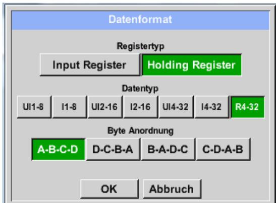
Mittels den Knöpfen *Input Register* und *Holding Register* wird der entsprechende Modbus-Registertyp ausgewählt.
