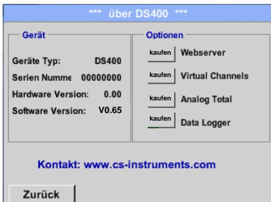
Durch Drücken des *Kaufen* Taste für „Analog Total“ werden Sie zur Eingabe des Freischaltcodes aufgefordert.
