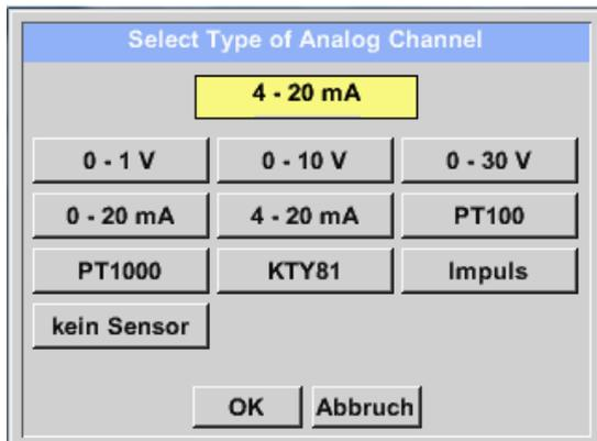
Auswahl des geforderten Sensortyps durch drücken des entsprechenden Taste, hier z.B.; 4-20mA
