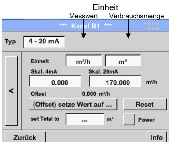
Auswahl der Einheiten durch drücken auf die entsprechenden Textfelder Einheit **Messwert** bzw. **Verbrauchsmenge**
