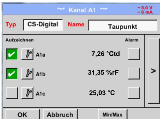
Das DS 400 erkennt, ob es sich bei dem angeschlossenen Sensor um ein Durchfluss- oder Taupunkt-Sensor von **CS Instruments** handelt und stellt den **CS-Digital** Subtyp automatisch richtig ein.
