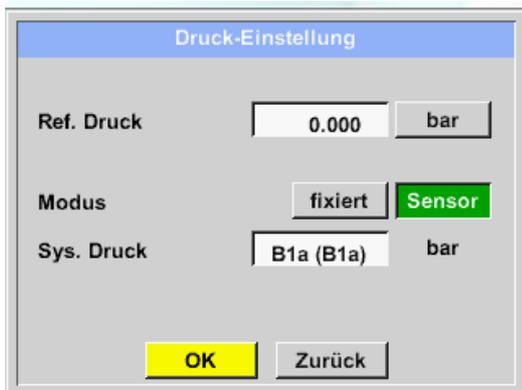
Bei Verwendung einer ext. Drucksonde, Erkennung ob Drucksonde verfügbar ist erfolgt automatisch z.B. hier am Sensoreingang B1, muss hierzu der Taste *Sensor* aktiviert werden.
