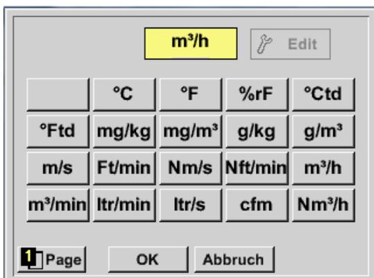
Die Auswahl der Einheit erfolgt durch drücken des gewünschten Einheiten- Taste. Die Übernahme der Einheit erfolgt durch betätigen des Taste *OK*.
