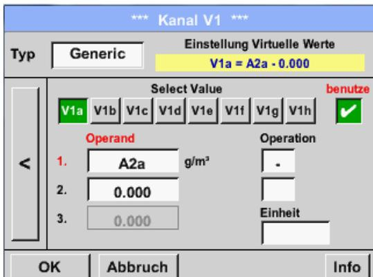
Durch drücken auf das Textfeld *Einheit* gelangen Sie in eine Liste mit den verfügbaren Einheiten
