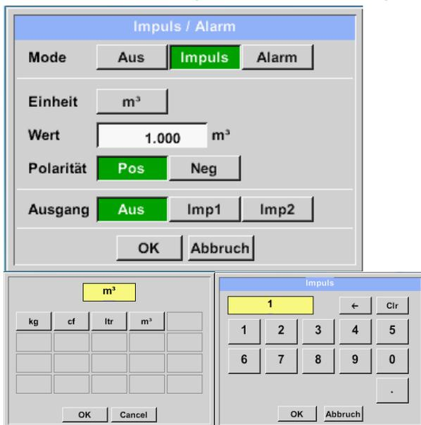
Für eine Verwendung des Impulsausganges müssen zuerst Pulswertigkeit und Pulseinheit definiert werden.
