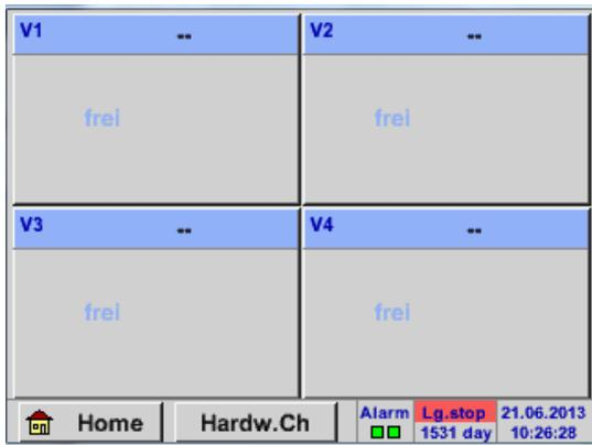
Nach Aktivierung der Taste „*Virtual Channels*“ im Sensor Einstellung Menü erscheint eine Übersicht der verfügbaren 4 Kanälen
