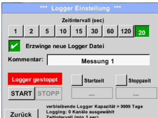
Durch Drücken des *Erzwingen-neue-Logger-Datei*-Taste wird eine neue Aufzeichnungsdatei angelegt und mit der Auswahl des *Kommentar*-Textfeldes kann ein Name oder Kommentar eingetragen werden.
