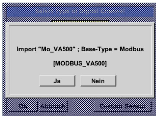
Zur Überprüfung werden ein Menü mit den Grunddaten des Sensors sowie der dazugehörige Kommentar angezeigt
