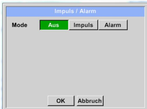
Der Impulsausgang der VA 5xx Sensoren kann sowohl als Impuls- wie auch als Alarmausgang definiert werden
