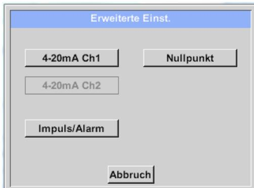
Dieses Menü ermöglicht die Einstellung / Zuordnung der Messwerte und die Skalierung des Analogausgang 4-20mA. Aktivierung durch betätigen der Taste „4-20mA Ch1“ durch Drücken der Taste *4-20mA Ch1*
