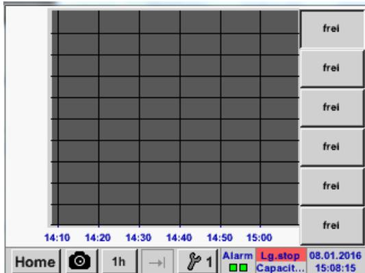
Hier können einer oder mehrere Kanäle für die Aufnahme und Darstellung von Messdaten, z. B. eines Taupunktsensors oder mehrerer verschiedener Sensoren, ausgewählt werden.
