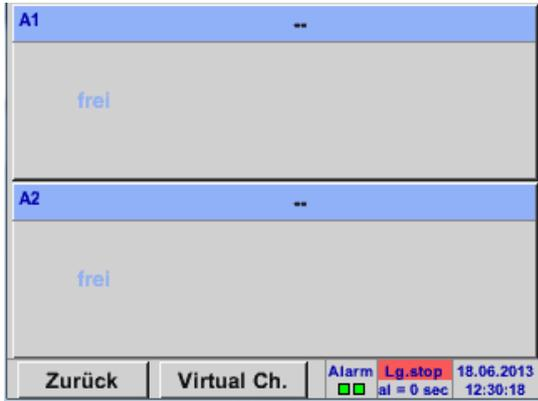
Nach der Eingabe des Passwortes erscheint eine Übersicht der verfügbaren Kanäle. Je nach Ausführung 2 oder 4 Kanäle.
