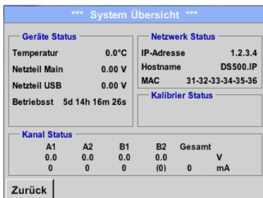
Der Menüpunkt *System-Übersicht* bietet Information über, die anliegenden Spannungen und Ströme der einzelnen und der gesamten *Kanäle*, sowie die Spannungsversorgung der *Netzteile an*. Darüber hinaus können hier die wichtigsten Netzwerkinformationen, wie *IP*, *Host* und *MAC* entnommen werden.
