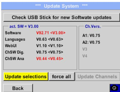
Ist das DS 400 korrekt mit dem USB-Stick verbunden und gibt es neue Versionen der einzelnen SW Parts werden diese in roter Schrift und mit <new> gekennzeichnet.
