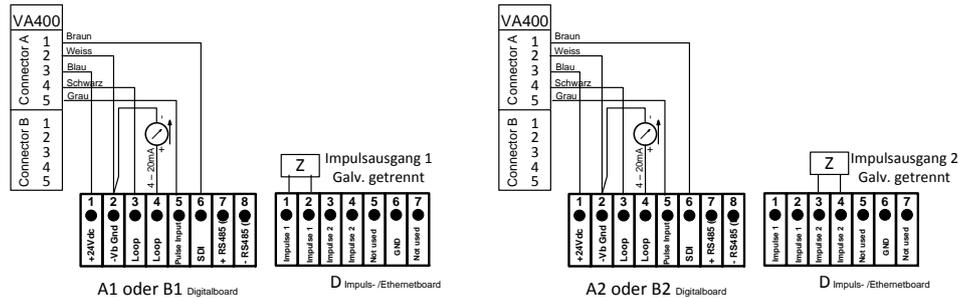
Bei Systemen mit 2 Digitalboards (2x2 Digitalkanäle) kann auf Impulsausgang 1 entweder Impulseingang A1 **oder** B1, sowie auf Impulsausgang 2 entweder Impulseingang A2 **oder** B2 geschaltet werden.
