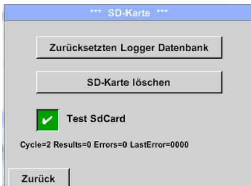
Mit Aktivierung *Test SdCard* wird ein Test der SD-Karte durchgeführt. Es werden Daten auf SD-Karte geschrieben und wieder gelesen. Die Anzahl der Test Zyklen sowie evtl. aufgetretene Fehler mit Fehlercode werden in der Statuszeile angezeigt.
