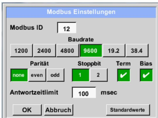
Hier wird die für den Sensor festgelegte *Modbus ID* eingetragen, zulässige Werte sind *1 – 247*, (Bsp. hier *Modbus ID = 12*)
