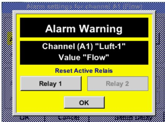
Bei Auftreten eines Alarm z.B. hier Alarm1 (gelb) von Kanal A1 wird eine Meldung eingeblendet. Wenn unter *Relais Settings* erlaubt wurde das Relais abzuschalten kann es durch betätigen den *Relais 1* Taste abgeschaltet werden. Die Meldung kann durch betätigen des *OK* Taste ausgeblendet.
