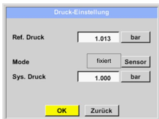
Referenz Druck ist der Druck auf den Drucktaupunkt bei Entspannung zurückgerechnet werden soll.
