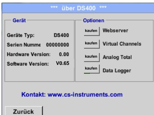
Durch Drücken der *Kaufen* Taste für „Analog Total“ werden Sie zur Eingabe des Freischaltcodes aufgefordert.
