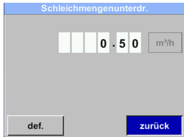
Abbildung 24: Schleichmengenunterdrückung anpassen (Beispiel)
