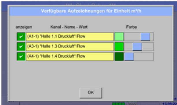
5. Es lassen sich auch mehrere Aufzeichnungen mit gleicher Einheit in einer y-Achse, mit Hilfe verschiedener Farbintensitäten, darstellen.
