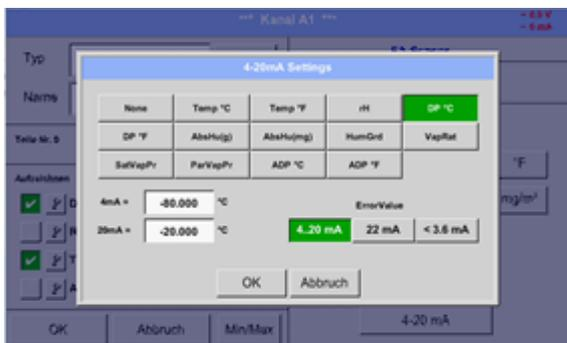
Dieses Menü erlaubt die Einstellung / Zuordnung des Messwertes und der Skalierung des Analogausganges. Auswahl des Messwertes durch Anwahl der entsprechenden Messwerttaste, hier z.B. „DP °C“ für Taupunkt °Ctd.
