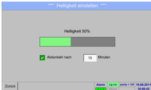
Mit Hilfe des *Abdunkeln-nach*-Knopfes kann, nach Ablauf eines zu definierenden Zeitintervalls (hier nach 15 Minuten), die *Helligkeit* auf das Minimum herabgesetzt werden.
