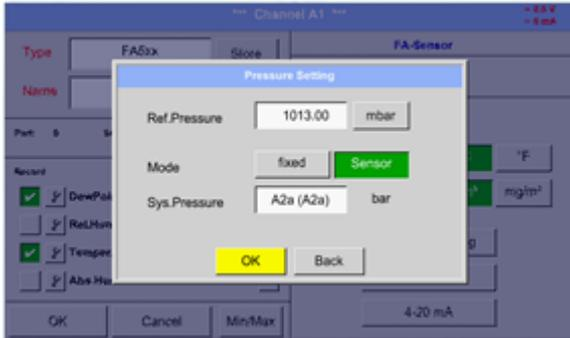
Bei Verwendung einer ext. Drucksonde, Erkennung ob Drucksonde verfügbar ist erfolgt automatisch z.B. hier am Sensoreingang B1, muss hierzu der Knopf *Sensor* aktiviert werden.
