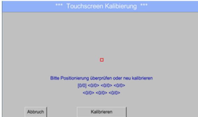
Falls nötig, kann hier die Bildschirmpositionierung geändert werden. **Kalibrieren** drücken und es erscheint, 1. links oben, 2. rechts unten und 3. in der Mitte ein Kalibrierungskreuz. Diese Kreuze müssen nacheinander gedrückt werden. Ist die Kalibrierung abgeschlossen und die Anzeige gemittelt, wird mit **OK** bestätigt. Ist dies nicht der Fall, so kann, mit Hilfe von **Abbruch** und durch ein erneutes Drücken von **Kalibrieren**, die Kalibrierung wiederholt werden.
