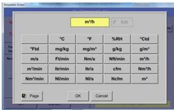
Die Auswahl der Einheit erfolgt durch drücken des gewünschten Einheiten-Knopfes. Die Übernahme der Einheit erfolgt durch betätigen des Knopf *OK*.
