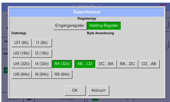
Mittels den Knöpfen *Input Register* und *Holding Register* wird der entsprechende Modbus-Registertyp ausgewählt. Mit *Data Type* und *Byte Order* wird das Zahlenformat und die Übertragungsreihenfolge der einzelnen Zahlenbytes festgelegt und sind in Kombination anzuwenden.
