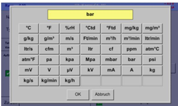
Eine voreingestellte Auswahl passender Einheiten bei *Typ 0 - 1/10/30 V* und *0/4 – 20 mA*.
