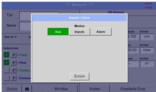
Der Impulsausgang der VA 5xx Sensoren kann sowohl als Impuls- wie auch als Alarmausgang definiert werden
