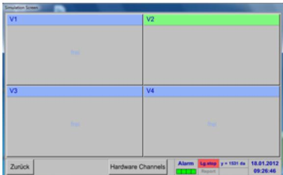
Nach Aktivierung des Knopfes „Virtual Channels“ im Sensor Einstellung Menü erscheint eine Übersicht der verfügbaren 4 Kanälen
