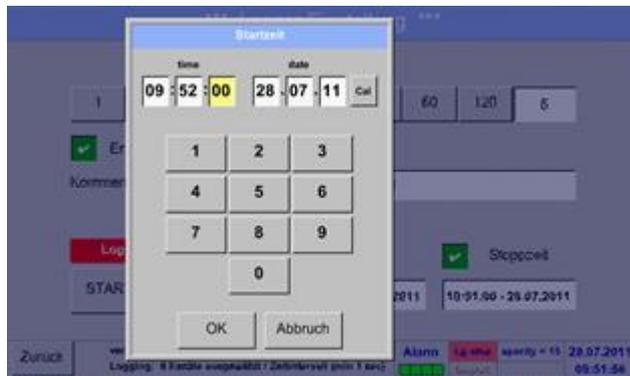
Nach dem Drücken des *Datum/Zeit-Textfeldes* erscheint das Eingabefenster, in welchem immer der gelb markierte Bereich der Uhrzeit oder des Datums eingestellt und geändert werden kann.
