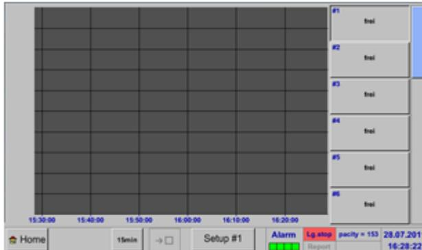
Hier können einer oder mehrere Kanäle für die Aufnahme und Darstellung von Messdaten, z. B. eines Taupunktsensors oder mehrerer verschiedener Sensoren, ausgewählt werden.
