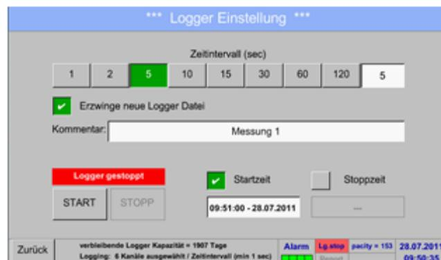
Durch Drücken des *Startzeit*-Knopfes und anschließend Drücken des Datum/Zeit-Textfeldes darunter, kann das Datum sowie die *Startzeit* der Datenlogger-Aufnahme eingestellt werden.
