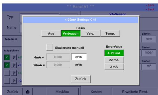
Mögliche Messwerte die zugeordnet werden können sind Durchfluss, Geschwindigkeit und Temperatur. Im Falle von Nichtanwendung des Analogausganges, wählen Sie bitte **Aus**.
