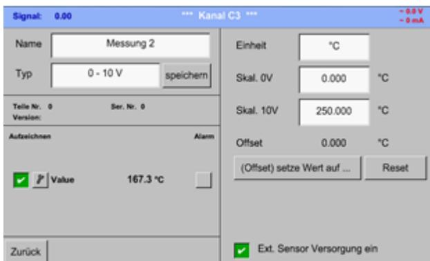
Die **Ext. Sensor-Versorgungsspannung** wird eingeschaltet, wenn der Sensortyp diese benötigt.
