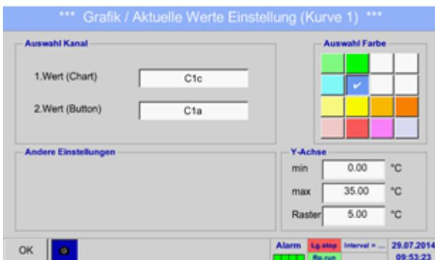
Hier wurde der Kanal C1 gewählt. Zu jedem Kanal kann ein Wert zur Darstellung in der *Grafik* und einer zum Anzeigen (*2. Wert*) ausgewählt werden. Darüber hinaus lässt sich, wie in *Hauptmenü* → *Grafik*, eine *Farbe* sowie die y-Achsen-Skalierung (*min*, *max*, *Raster*) bestimmen.
