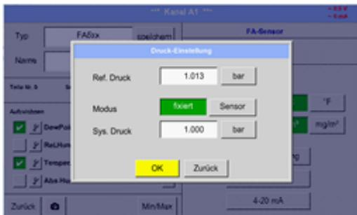
Referenz Druck ist der Druck auf den Drucktaupunkt bei Entspannung zurückgerechnet werden soll.
