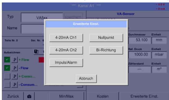
Dieses Menü ermöglicht die Einstellung / Zuordnung der Messwerte und die Skalierung des Analogausgang 4-20mA. Aktivierung durch betätigen der Taste „4-20mA Ch1“ durch Drücken der Taste **4-20mA Ch1**
