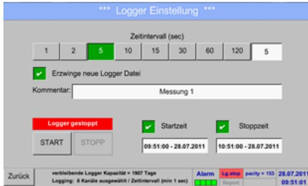
Durch Drücken des *Stoppzeit*-Knopfes und anschließend Drücken des Datum/Zeit-Textfeldes darunter, kann das Datum sowie die Uhrzeit für das Ende der Datenlogger-Aufnahme eingestellt werden.
