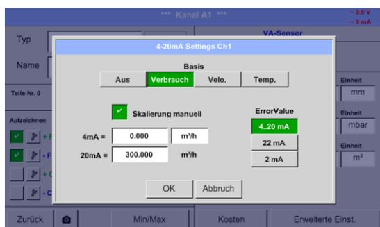
Die manuelle Skalierung muss durchsetzen **Skalierung manuell** aktiviert werden. In den Textfeldern **4mA** und **20mA** werden die entsprechenden Skalierungswerte, in dem Beispiel "Null" m³/h (4mA) bis 300 m³/h (20mA).
