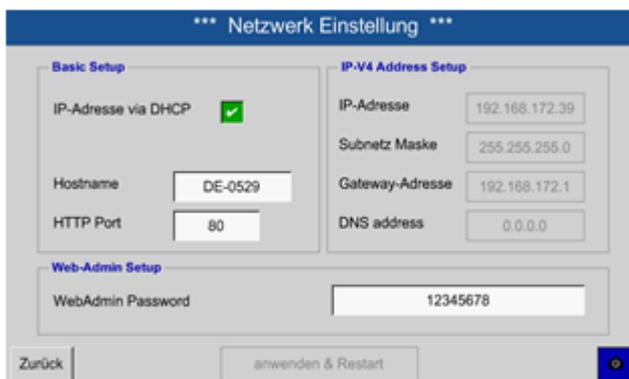
Hier kann eine Verbindung, mit oder ohne *DHCP*, zu einem Rechner eingerichtet und hergestellt werden.
