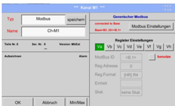
Via Modbus können bis zu 8 Registerwerte (aus Input oder Holding Registern) des Sensors ausgelesen werden.
