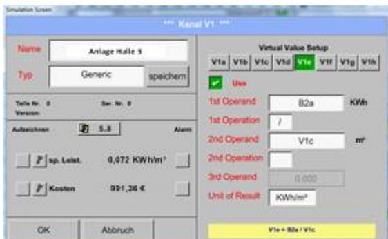
Berechnung der *spez. Leist.* erfolgt hier mit  $V1e = B2 / V1c$  mit Resultat 0,072 kWh/m³
