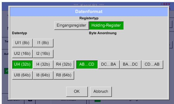
Auswahl Register Type *Holding Register*, Data Type *UI1(32b)* und Byte Order *A-B-C-D*
