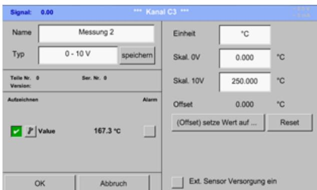
Die Skalierung des Sensors (hier zum Beispiel **Typ 0 – 10 V** entspricht 0 – 250 °C) entnehmen Sie bitte dem Datenblatt ihres angeschlossenen Sensors.
