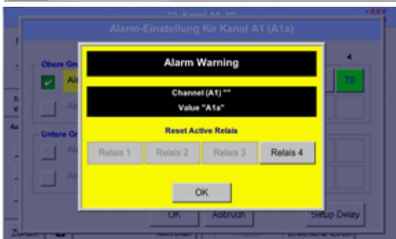
Bei einer Aktivierung der *Relais*-Knöpfe ist es möglich mittels der angezeigten Alarrmeldung eine Relaisabschaltung zuzulassen.
