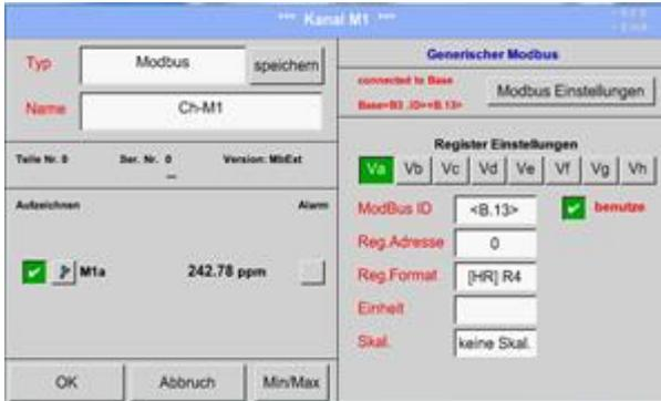
Die *Modbus ID* wird bei Erstaktivierung als Kopie der *Modbus Einstellungen* des Basiskanals (Kennzeichnung: Wert in < >) übernommen, kann aber überschrieben werden.
