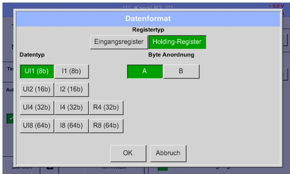
Auswahl Register Type *Holding Register*, Data Type *UI1(8b)* und Byte Order *A / B*
