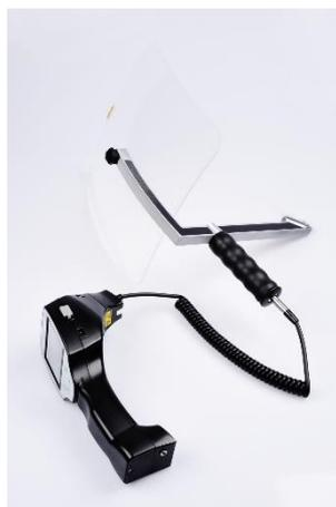
**Hinweis:** Für die Verwendung des Parabolspiegels und Schwanenhalses müssen diese Komponenten bei Erstinbetriebnahme im LD 500 aktiviert werden, um die komponentenspezifischen Abgleichparameter zu speichern. Falls dies nicht schon ab Werk durchgeführt wurde werden die Daten hierfür per USB-Stick mitgeliefert. Für die Aktivierung (Parameter Import) , siehe Kapitel 10.2 „ Export / Import“.
