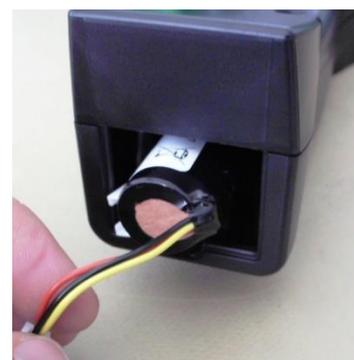
*Entfernen der Akku-Abdeckung Trennen der Steckverbindung Vorsichtig den Akku herausziehen*
