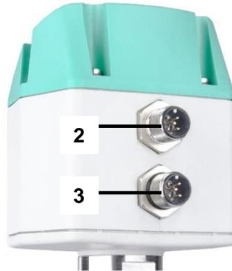
2 Anschlussstecker: Modbus RTU, Spannungs-/Stromversorgung, 4...20 mA Ausgang: M12-Einbaustecker, 5-polig, A-codiert
