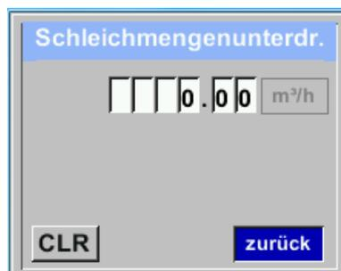
Die Schleichmengenunterdrückung kommt in Anwendung um Verbrauchswerte unterhalb des definierten „LowFlow Cut off“ Wertes als 0 m<sup>3</sup>/h anzuzeigen und auch nicht zum Verbrauchzählerstand zu addieren.
