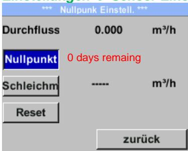
Zeigt der Sensor im Display die Meldung „CalZeroPnt“ dann sollte eine Nullpunktkalibrierung durchgeführt werden, siehe hierzu auch Kapitel „Inbetriebnahme“.
