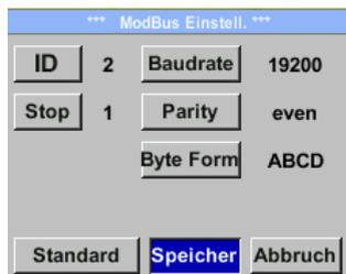
Um Änderungen, z.B. der Sensor ID, vorzunehmen, wird mittels Taste „**Δ**“ das Feld „**ID**“ selektiert und anschließend mit Taste „**OK**“ ausgewählt.
