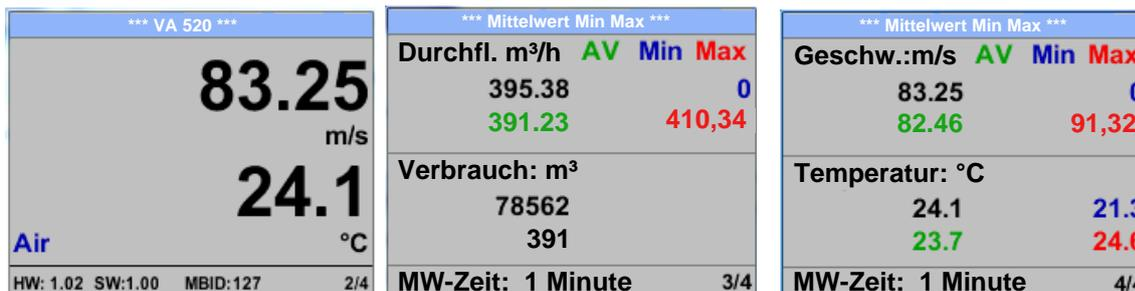
Die MW-Zeit (Zeitraum der Mittelwertbildung) kann über *Sensor Einst. - Erweitert – MW-Zeit* geändert werden.
