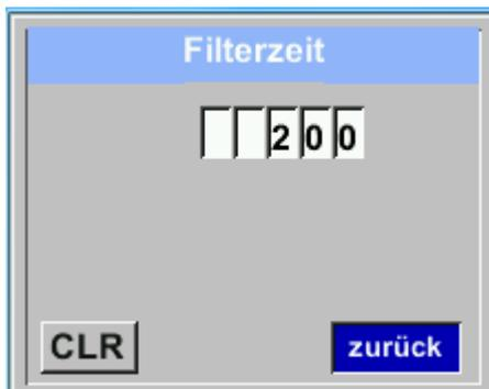
Unter dem Punkt „**Filterzeit**“ kann eine Dämpfung festgelegt werden. Eingabe Werte von 0 -10000 in [ms] sind möglich.
