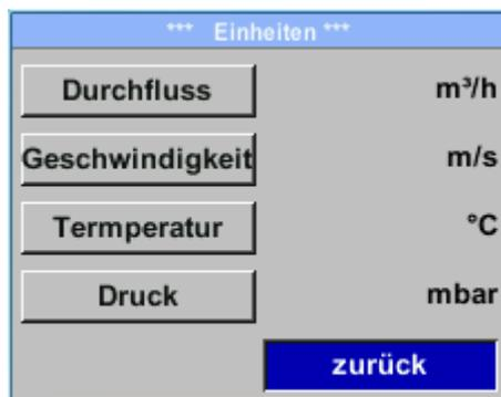
Um Änderungen der Einheit für den jeweiligen Messwert vorzunehmen muss mittels Taste „ $\Delta$ “ das Tastenfeld des Messwertes angewählt werden und mit Taste „OK“ aktiviert werden.
