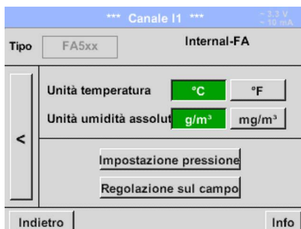
Figura 33: Impostazione dei parametri di riferimento e della calibrazione (esempio)
