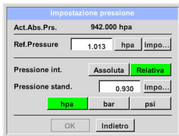
Figura 34: Configurare le impostazioni di pressione (esempio)
