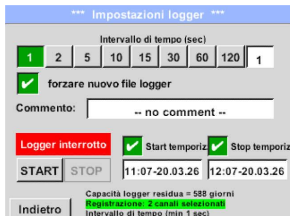
Figura 51: Configurare la registrazione dei dati (esempio)
