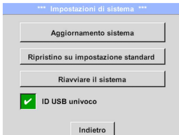
Figura 22: Ripristino delle impostazioni di fabbrica (esempio)
