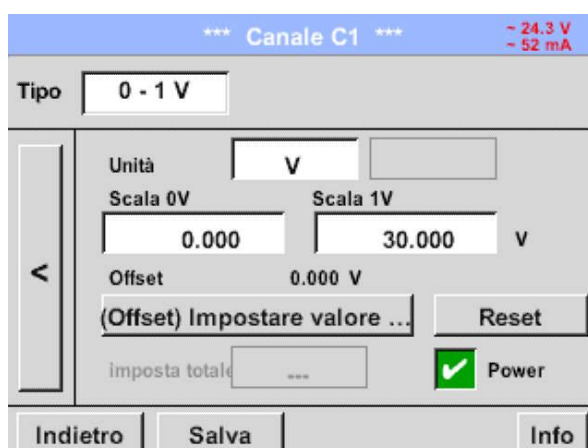
Figura 42: Configurazione del sensore analogico (esempio)
