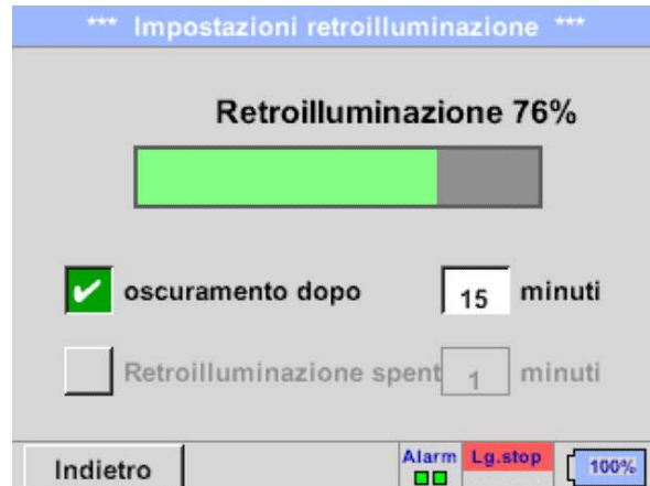
Figura 8: Impostazione della luminosità del display e della modalità standby (esempio)
