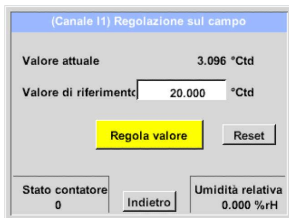
Figura 35: Eseguire la calibrazione a punto singolo (esempio)
