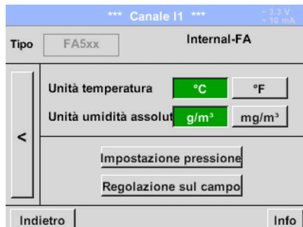
Figura 27: Impostazione dei parametri di riferimento e della calibrazione (esempio)
