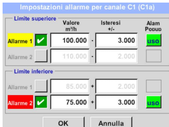
Figura 32: Impostare l'allarme (esempio; Allarme 1 = giallo, Allarme 2 = rosso)
