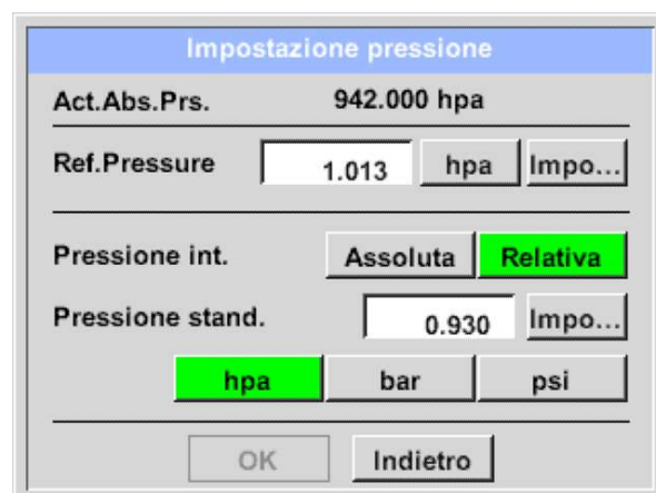
Figura 28: Configurare le impostazioni di pressione (esempio)
