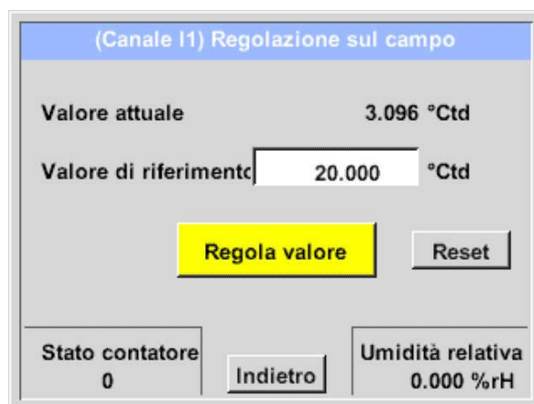
Figura 29: Eseguire la calibrazione a punto singolo (esempio)
