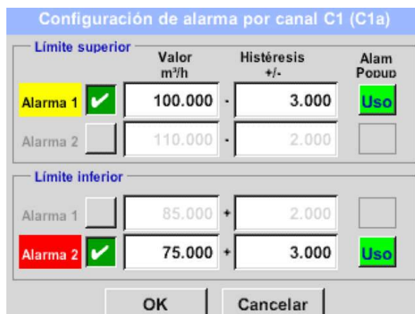
Figura 14: Configurar la alarma (ejemplo; alarma 1 = amarillo, alarma 2 = rojo)
