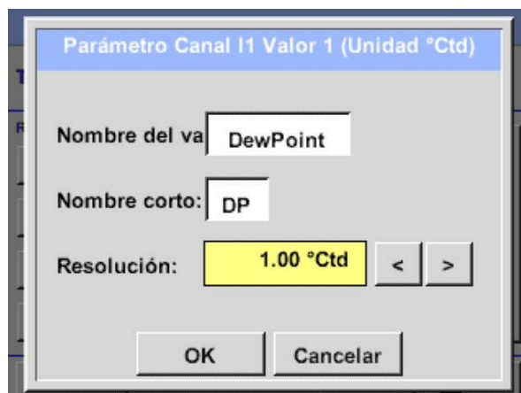
Figura 12: Configurar la denominación y la resolución de los valores medidos (ejemplo)
