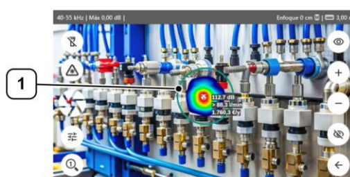
Figura 21: Fuga detectada de forma óptima (ejemplo)
