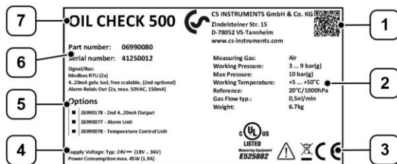
Figura 2: Placa de características (ejemplo)
