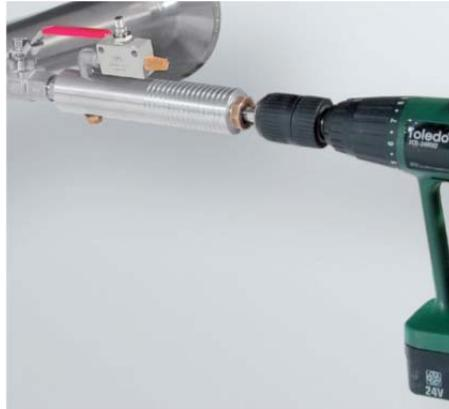
En caso de que el tubo no se pudiera despresurizar podrían usar el collarin de perforación con punto de CS ( Núm. De pedido 0530 1108 ) y la plantilla de perforación ( . Order-No 0530 1108 ) para perforar a través de la válvula de bola.
