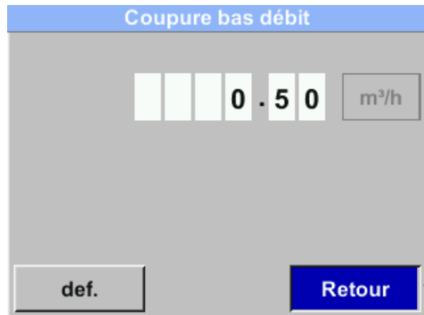
Figure 24: Adapter la suppression des débits faibles (exemple)
