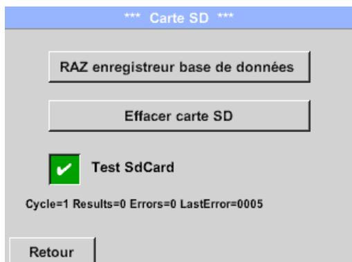
L'activation de *Test SdCard* permet d'effectuer un test de la carte SD. Les données sont écrites et relues sur la carte SD.
