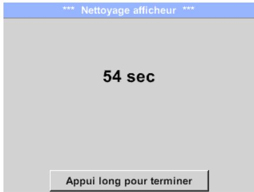
Cette fonction peut être utilisée pour le nettoyage de l'écran tactile alors que la mesure est en cours d'exécution.
