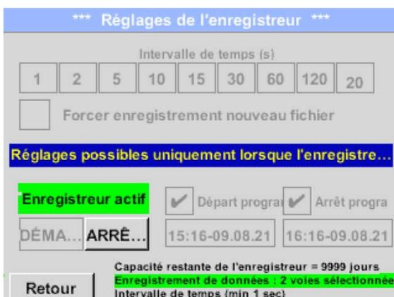
L'enregistreur de données peut être activé et désactivé également si aucun temps n'a été réglé, au moyen des boutons *Démarrage* et *Arrêt*.
