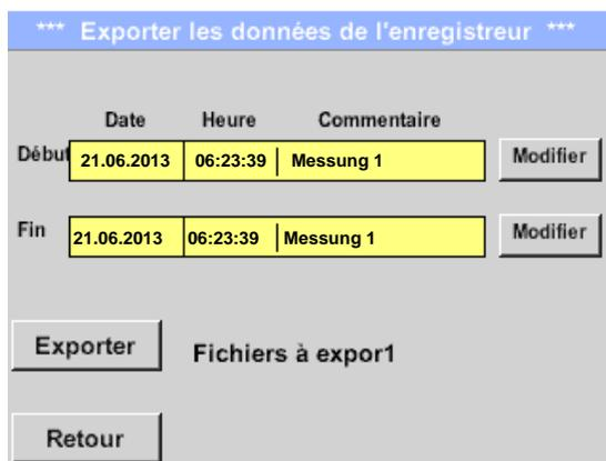
Le bouton *Sélection* permet de régler un espace de temps entre *Démarrage* et *Arrêt*. Les données de mesure sauvegardées enregistrées pendant ce laps de temps sont exportées.
