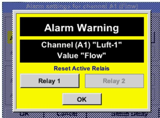
Si les boutons *Relais* sont activés, il est possible d'admettre une désactivation des relais via l'alarme affichée.
