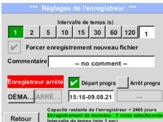
Dans la ligne supérieure, il est possible de sélectionner les *Intervalles temporels* d'enregistrement prédéfinis avec 1, 2, 5, 10, 15, 30, 60 et 120 secondes.
