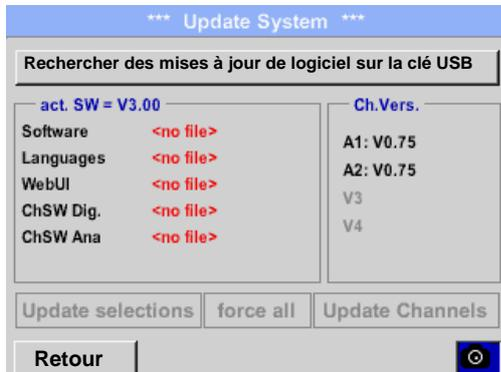
Si les messages suivants s'affichent dans la fenêtre après avoir appuyé sur la touche *Rechercher des mises à jour de logiciel sur la clé USB*, cela signifie que le DS 400 n'est pas correctement connecté à la clé USB ou qu'il n'y a pas de fichiers.
