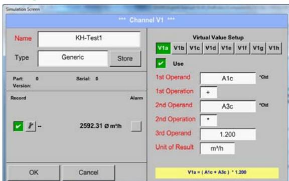
Avec les boutons d'*enregistrement*, on sélectionne les données de mesure à sauvegarder via l'**enregistreur de données activé**.
