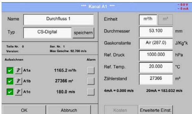
Avec les boutons d'*enregistrement*, on sélectionne les données de mesure à sauvegarder via l'**enregistreur de données activé**.
