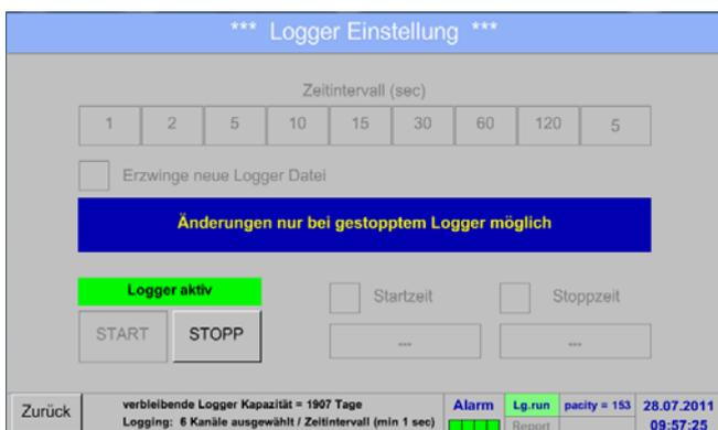
L'enregistreur de données peut être activé et désactivé également si aucun temps n'a été réglé, au moyen des boutons *Démarrage* et *Arrêt*.
