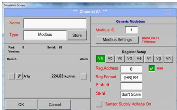
Le capteur stocke les valeurs de mesure dans des registres et celles-ci peuvent être adressées et lues via le Modbus du DS500. À cet effet, les adresses des registres souhaitées doivent être réglées dans le DS500.
