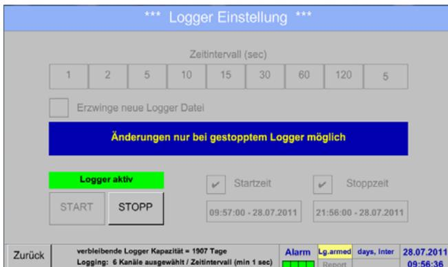
Après avoir activé *Temps de démarrage* ou *Temps d'arrêt* et effectué le réglage, il faut appuyer sur le bouton *Démarrage* ; l'enregistreur de données est ajusté sur *armed* (activé).
