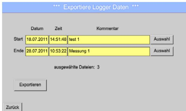
Le bouton *Sélection* permet de régler un espace de temps entre *Démarrage* et *Arrêt*. Les données de mesure sauvegardées enregistrées pendant ce laps de temps sont exportées.
