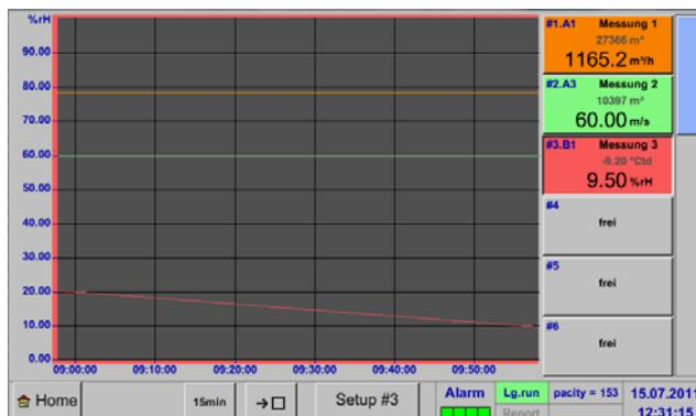
Si l'on n'entre pas d'échelle pour les axes y dans les réglages, *min* est mis sur 0, *max* est mis sur 100 et la *trame* est mise sur 10 (réglage #3).
