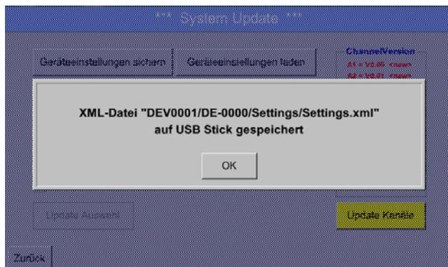
Sauvegarde les *Réglages du système et des canaux* en format XML sur une clé USB.
