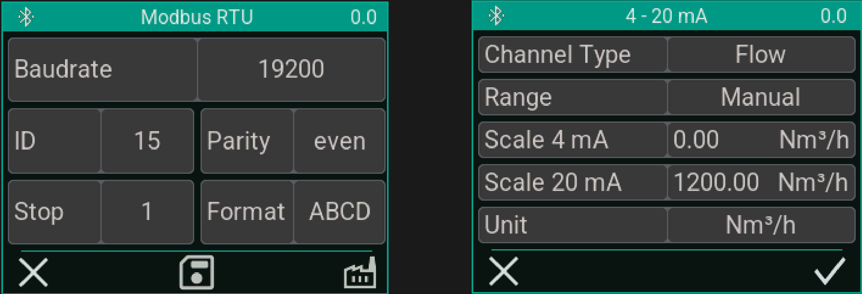
Figur 3: Modbus-gränssnitt och analog utgång kan konfigureras separat
