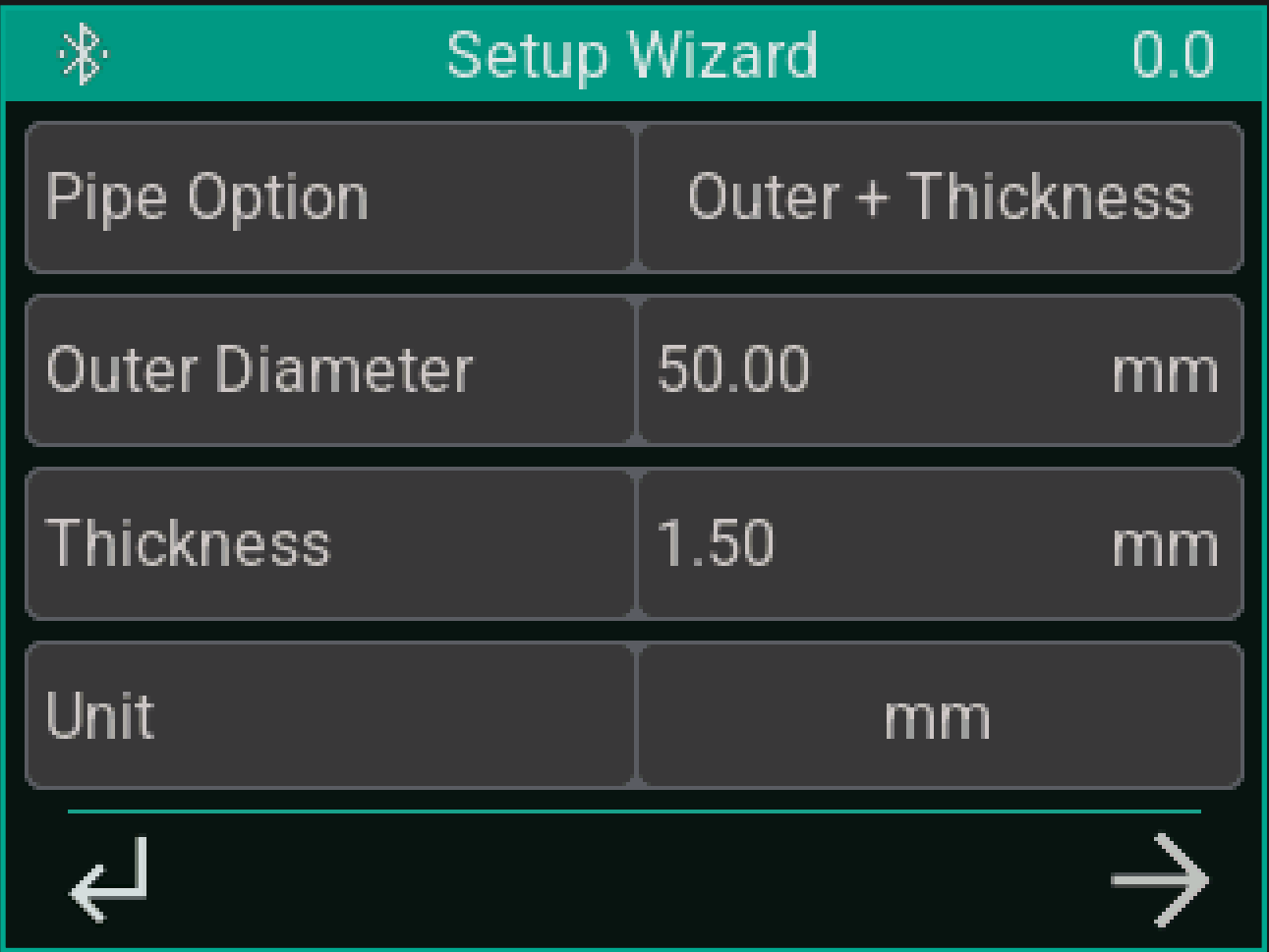
Figur 2: Enkel inmatning av rördimensioner på enheten
