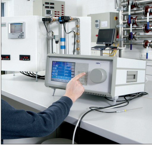
校准范围: -80 至 20^{\circ}\text{Ctd} - DKD 参考精度: 0.1^{\circ}\text{Ctd}
