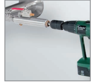
CS delme tertibatı ile basınç altında delme
