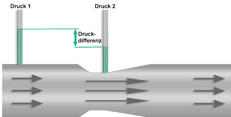
Bei der Differenzdruckmessung führen zwei getrennte Leitungen zu einer Differenzdruckmesszelle. Ein Druckanschluss (Druck 1) befindet sich am Eingang des Venturi-Rohrs und ein zweiter Druckanschluss befindet sich am Ausgang des Venturi-Rohrs (Druck 2). Ohne Durchfluss ist der Druck am Eingang und Ausgang identisch.
