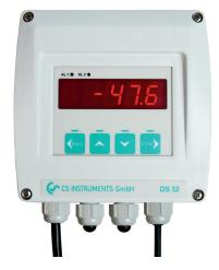
Mit der LED-Prozess-Anzeige DS 52 im formschönen Wandgehäuse entfällt das lästige Suchen und der Einbau in ein passendes Kunstoffgehäuse. Das DS 52 verfügt über 2 potenzialfreie Alarmkontakte (Wechsler), die max. mit 230 VAC, 3 A belastet werden können. Die Alarmgrenzen sind per Tasten frei einstellbar.
