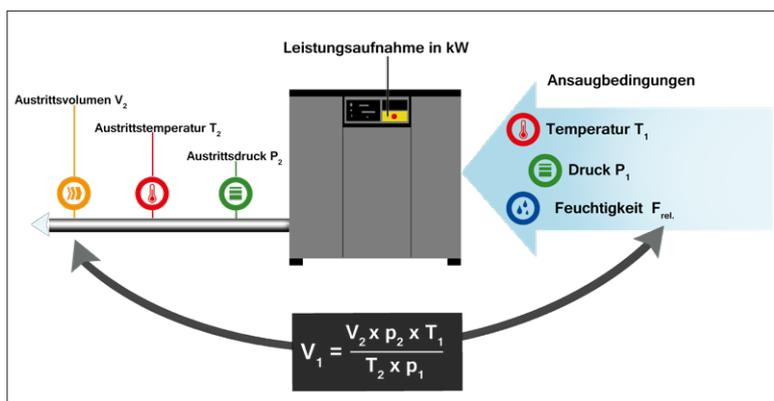
Die freie Förderluft von Kompressoren ist abhängig von der Ansaugluft.
