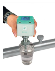
Der Sensor kann ausgebaut und gereinigt werden
