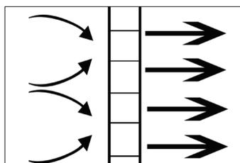
Integrierter Strömungsgleichrichter - keine Einlaufstrecken notwendig
