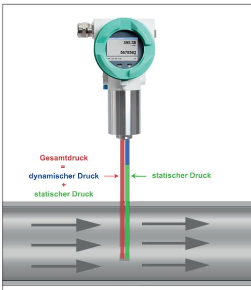
Durch den integrierten, präzisen Differenzdrucksensor wird der Differenzdruck/Staudruck an der Sensorspitze gemessen. Dieser ist abhängig von der jeweiligen Gasgeschwindigkeit. Anhand des Rohrdurchmessers kann somit einfach auf den Durchfluss geschlossen werden.
