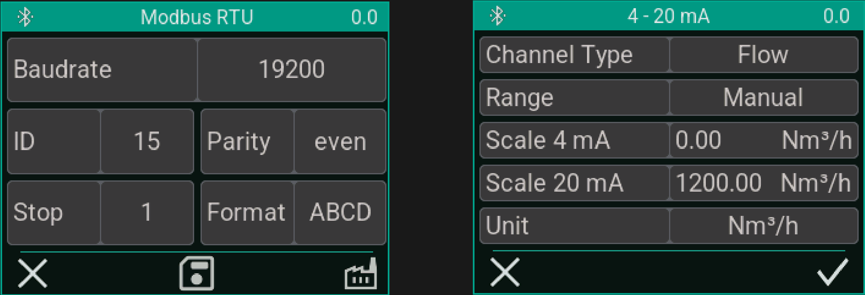
Figure 3 : Interface Modbus et sortie analogique réglables individuellement
