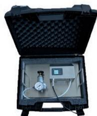
Mesure de la qualité de l'air comprimé
