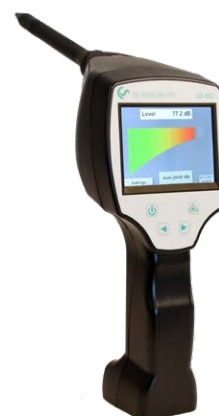
LD 450 avec le tube pointage pour une meilleur précision
