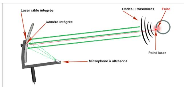
La parabole assure la concentration des ondes ultrasoniques et permet la détection des fuites mineures à partir de 0,8l/min (approximativement un coût de 8€ par an). Par ailleurs l'utilisateur pourra localiser des fuites à une distance de 10 à 15 mètres avec une précision de  $\pm 15$  cm.
