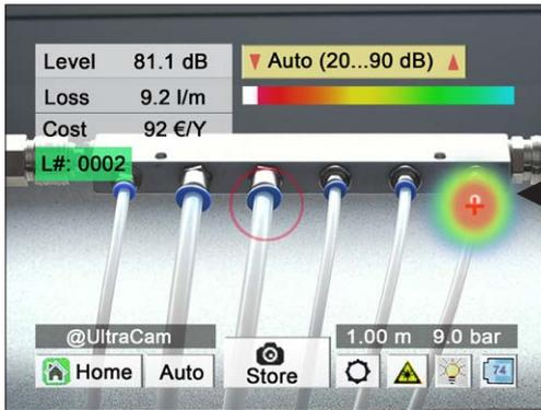
L'UltraCam LD 500/510 utilise 30 micros MEMS pour calculer et visualiser l'image par ultrasons. De plus, l'appareil rend les ultrasons audibles
