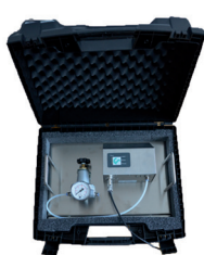
Medición de la calidad del aire comprimido
