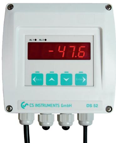
Con el indicador LED de proceso DS 52 en la hermosa caja de pared no es necesaria la búsqueda ni el montaje en una caja de plástico adecuada. El DS 52 dispone de 2 contactos de alarma sin potencial (conmutadores), que se puede cargar como máx. con 230 VCA 3 A. Los umbrales de alarma se pueden configurar libremente con las teclas.
