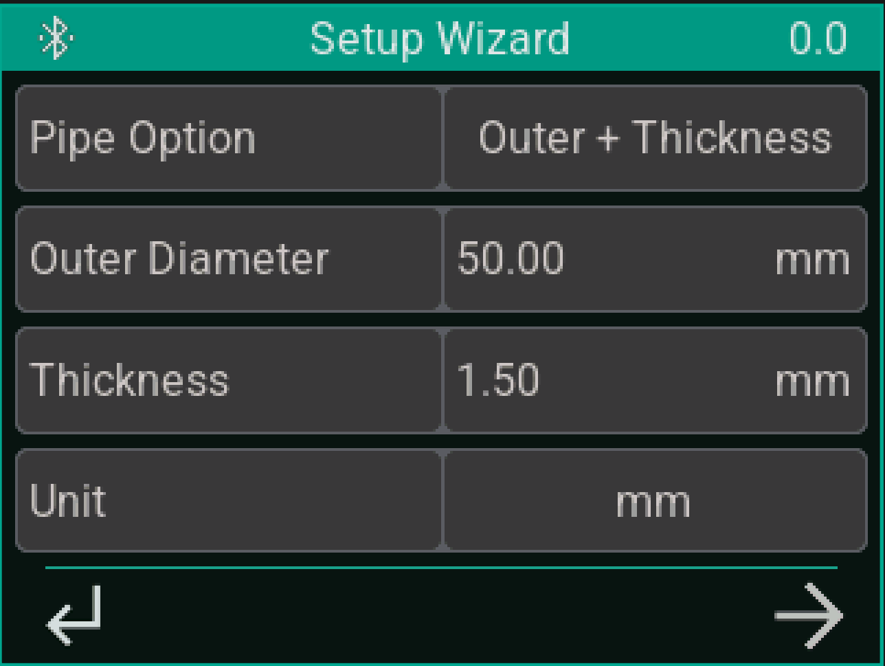
Figura 2: Introducción sencilla de las dimensiones de las tuberías en el dispositivo
