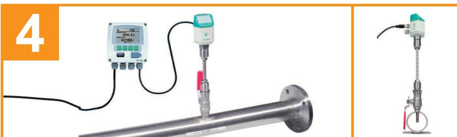
El aprobado caudalímetro VA 400 se encuentra disponible para diámetros de tubería de 2" a DN 300. Su sofisticado y constructivo diseño permite la instalación en tuberías con diámetros nominales de hasta DN 300 incluso bajo presión. Su instalación se consigue mediante una válvula de esfera estándar de 1/2".
