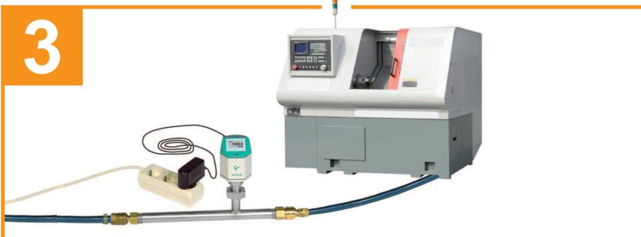
Mediante acoples rápidos, el medidor de aire comprimido se puede integrar rápidamente en la tubería de entrada de una máquina. Durante el apagado de la máquina, se podrá determinar el porcentaje de fugas, mientras que el consumo real se obtendrá con la máquina en marcha. La fuente de alimentación se pone en funcionamiento desde la toma de energía mediante la unidad de corriente. Para una toma de datos prolongada, recomendamos utilizar el analizador de aire comprimido móvil DS 300.
