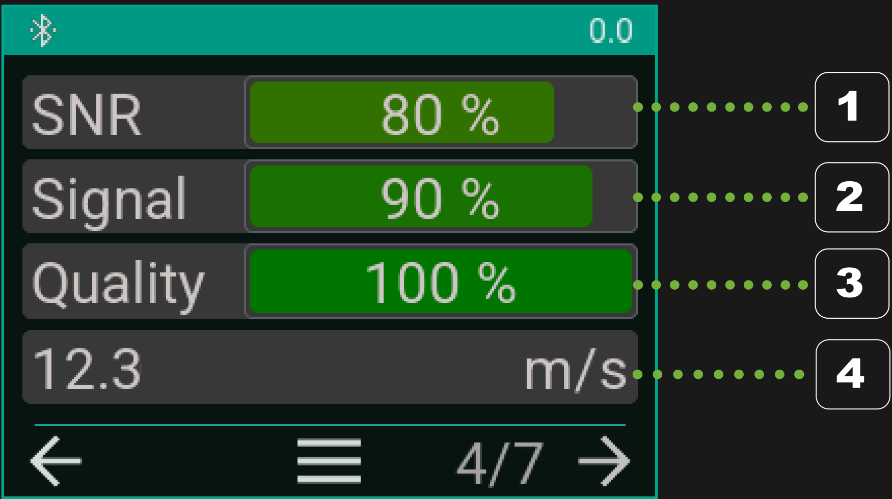
Figura 1: 1 Rapporto segnale-rumore / 2 Potenza del segnale / 3 Frequenza di contatto / 4 Velocità operativa
