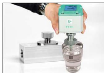
È possibile rimuovere il sensore dal blocco di misura e pulirlo.
