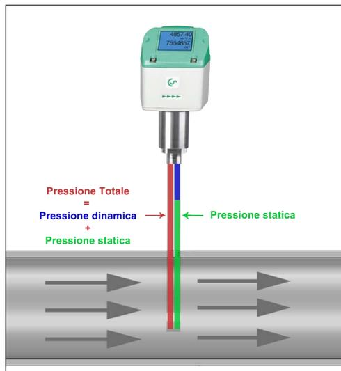
Il sensore di pressione differenziale integrato misura la pressione differenziale/pressione dinamica direttamente sull'estremità della sonda. La pressione differenziale è funzione della velocità del gas. In base al diametro del tubo è quindi facile determinare la portata dell'aria o del gas.
