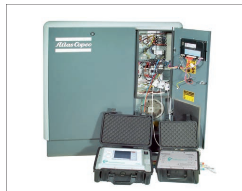
Esempio: misura su compressore
