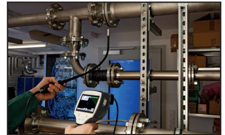
Como los conductos de aire comprimido pueden estar en lugares con difícil acceso, se puede usar un cuello cisne flexible. Ese cuello se usa como prolongación del brazo para las fugas más alejadas y en lugares de difícil acceso.
