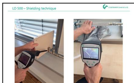
Las fugas de aire comprimido generan un potente campo de ultrasonido que, en determinadas circunstancias, puede generar una señal de ultrasonido en todo el recinto.
