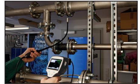
Comme les conduites d'air comprimé sont en partie dans un espace difficilement accessible, il est possible d'utiliser un col de cygne flexible. Il sert de prolongement du bras pour des fuites éloignées et difficilement accessibles.
