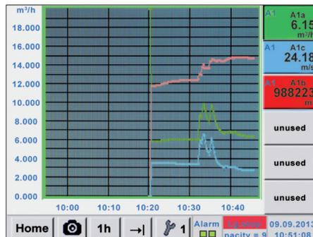
In questo modo l'operatore potrà visualizzare curve di misura memorizzate anche senza PC, in qualsiasi momento, in loco. Ciò consente di effettuare un'analisi dell'aria compressa e del consumo di gas in modo rapido e facile.
