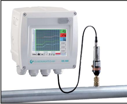
Il kit punto di rugiada DS 400 si compone di registratore videografico DS 400 e sensore punto di rugiada FA 510, comprende anche camera di misura per la misura del punto di rugiada in pressione di aria compressa e gas fino a 16/50/350 bar.
