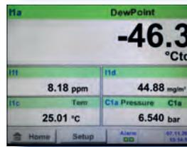
Alle physikalischen Messgrößen der Feuchtemessung werden automatisch berechnet. Beim DP 510 werden zusätzlich die Messwerte des externen Fühlers angezeigt.
