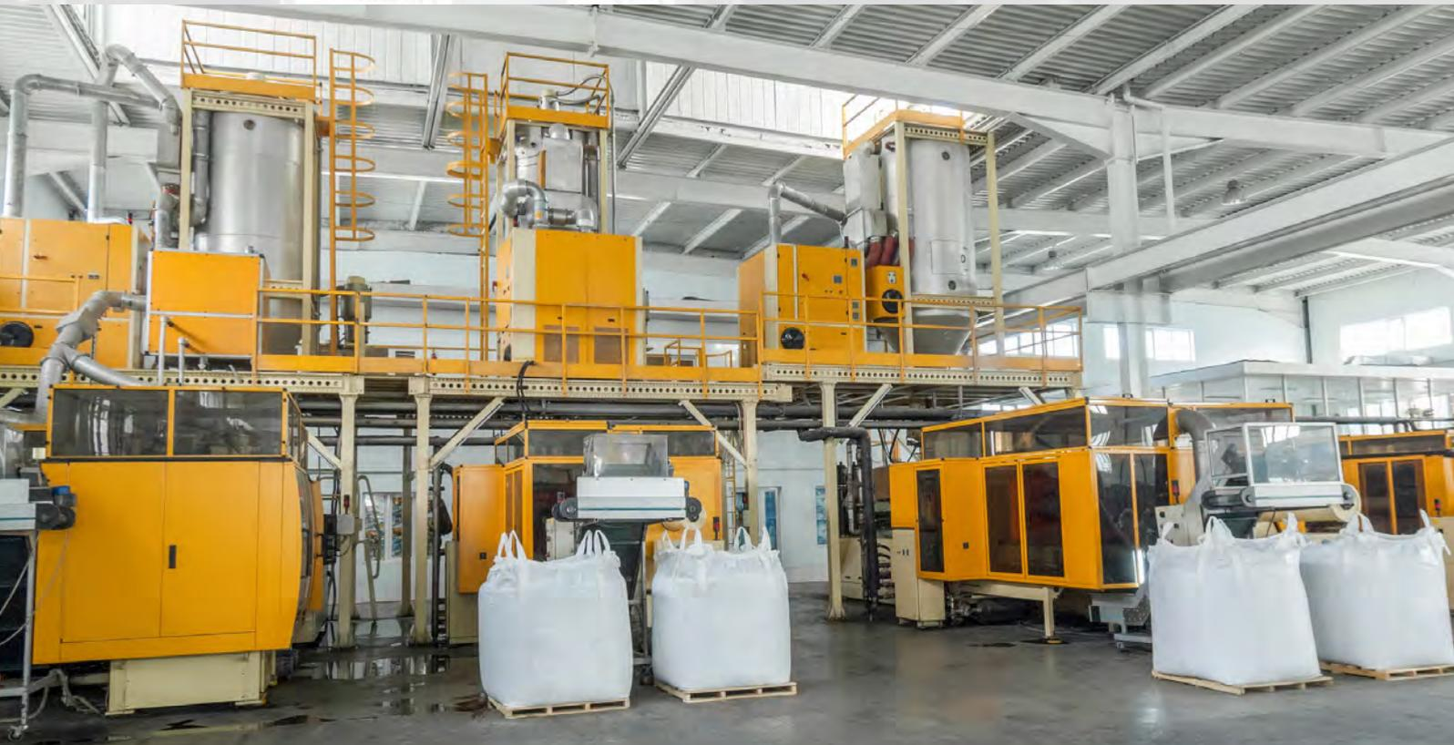
Ist der Kunststoff bei der Verarbeitung in Spritzgießmaschinen nicht optimal getrocknet, hat dies vielfältige negative Auswirkungen auf das Endprodukt. So können z.B. bei der Verarbeitung von zu feuchtem Kunststoff Blasen oder Schlieren auf der Oberfläche erscheinen, oder die Maßhaltigkeit ist nicht gegeben.
