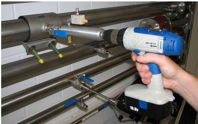
Gaurire cu sistem de ghidare. Cod de comanda: 0530 1108
