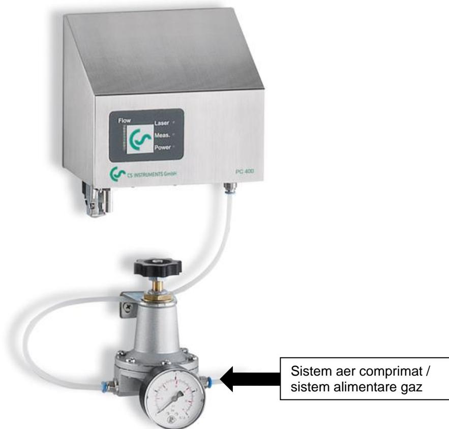
**Important:** Presiunea la intrarea in numaratorul de particule PC 400 nu trebuie sa depaseasca 1,6 bar (suprapresiune). Presiunea trebuie redusa in mod corespunzator cu ajutorul regulatorului de presiune livrat impreuna cu instrumentul PC 400.
