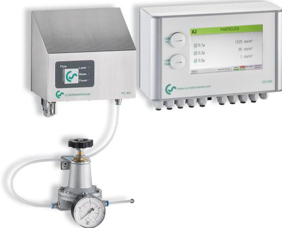
Transferarea valorilor masurate de la numaratorul de particule PC 400 catre inregistratorul DS 500 se face cu ajutorul interfetei digitale RS 485 (protocol Modbus).
