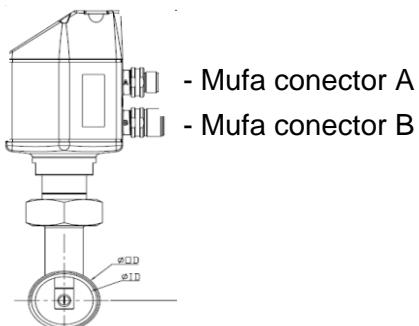
**Atentie:** Conexiunile NC neutilizate nu trebuie legate la tensiune si/sau la impamantare.
