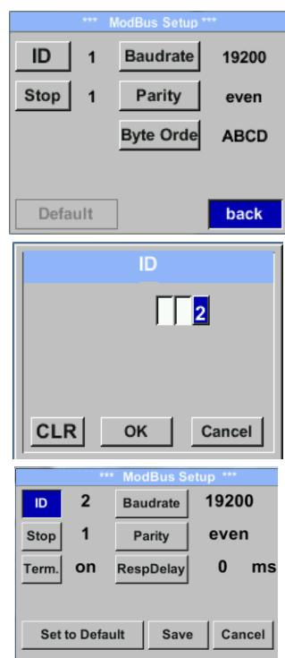
Pentru efectuarea unei modificari, de exemplu ID-ul senzorului, alegeti mai intai campul „**ID**” apasand tasta „ $\Delta$ ” si apoi confirmati cu tasta „**OK**”.
