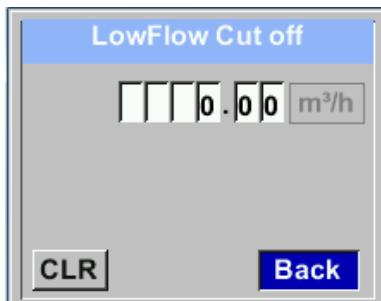
Cu optiunea Low-flow cut off activata, debitul mai mic decat valoarea definita pentru "LowFlow Cut off" va fi afisat ca  $0 \text{ m}^3/\text{h}$  si nu va fi adaugat la valoarea contorului.
