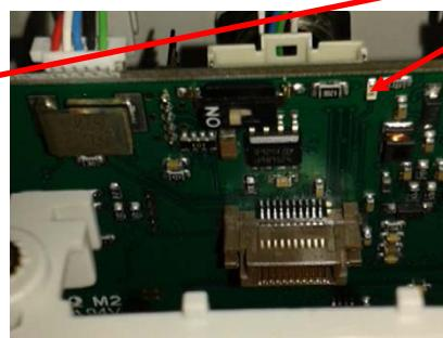
Alternativ, se va conecta un rezistor 120  $\Omega$  intre pinii 2 si 4 ai conectorului “A”.
