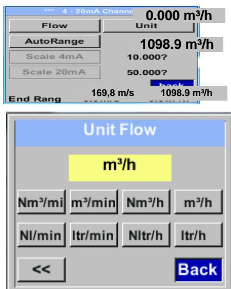
Iesirea analogica 4-20 mA a senzorului VA 520 poate fi ajustata automat “Auto Range = on” sau manual “Auto Range = off”.
