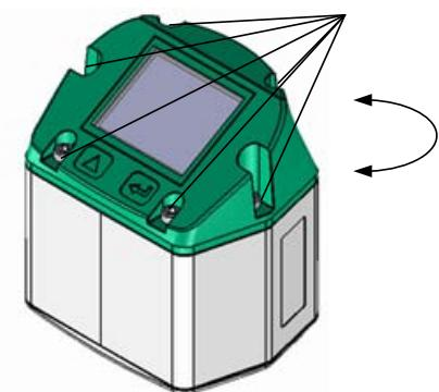
Pozitia afisajului poate fi rasucita cu 180°, de exemplu in cazul inversarii directiei de curgere a fluxului de aer sau de gaz. Pentru aceasta, desfaceti cele 6 suruburi de blocare si rotiti afisajul cu 180°.
