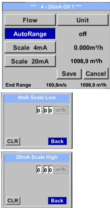
Iesirea analogica 4-20 mA a senzorului VA 520 poate fi ajustata automat "Auto Range = on" sau manual "Auto Range = off".
