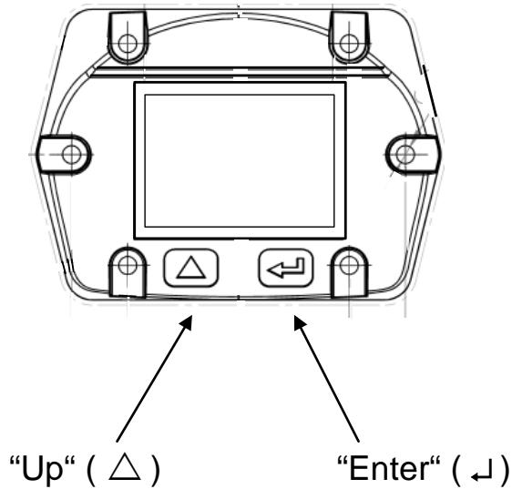
Operarea senzorului VA 520 se face cu ajutorul celor două taste capacitive Up ( $\triangle$ ) și Enter ( $\leftrightarrow$ ).
