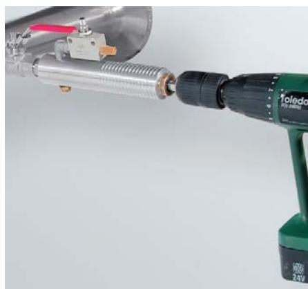
In cazul in care sistemul nu poate fi oprit si nu poate fi depresurizat, se va utiliza un manson de etansare a conductei (de exemplu: cod comanda 0500 0446) si sistemul de gaurire sub presiune (cod comanda 0530 1108) pentru realizarea unei gauri prin valva cu bila.
