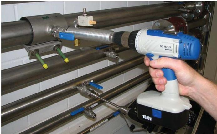
Bohren mit der CS Bohrvorrichtung
